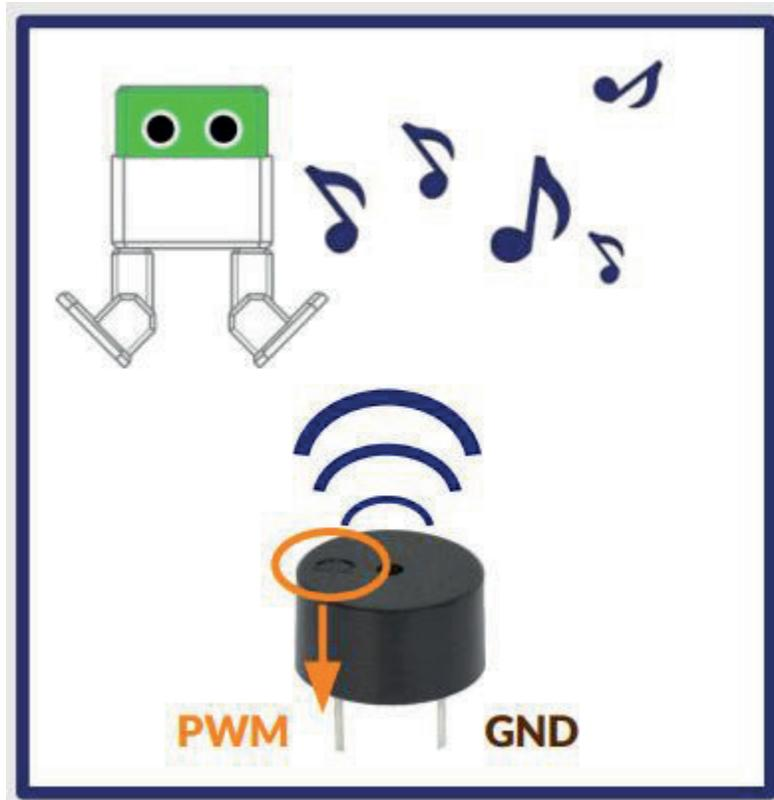
Recordemos el pin de conexión del buzzer
