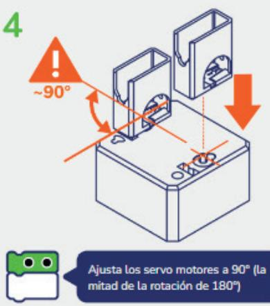
Ajusta los servo motores a 90° (la mitad de la rotación de 180°)
