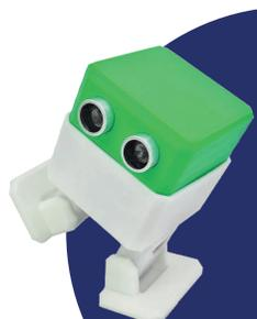
2. No lo fuerces. El servomotor está compuesto por pequeños engranajes plásticos que pueden desencajar o dañarse si su eje es manipulado manualmente, lo mejor será utilizar la programación para centrarlos o alinearlos
